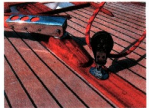
Ci-dessus L'écoute de grand-voile passe dans une poulie derrière la barre avant de rejoindre le cockpit via la bôme.
