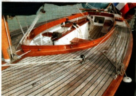
Das offene Cockpit ist durch ein hohes, formschönes Süll gegen Wasser geschützt
