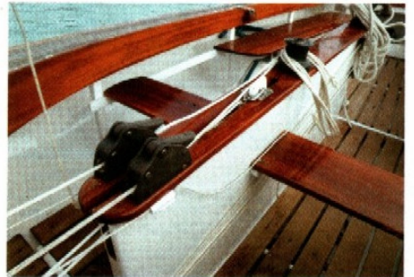
Schwertkasten mit Fockschotwinde. Das unprofilierte Stahlschwert vibriert stark
