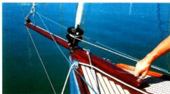
Six plis d'acajou, cinq feuilles de carbone, le bout-dehors est solide et se démonte facilement à l'aide de deux vis.
